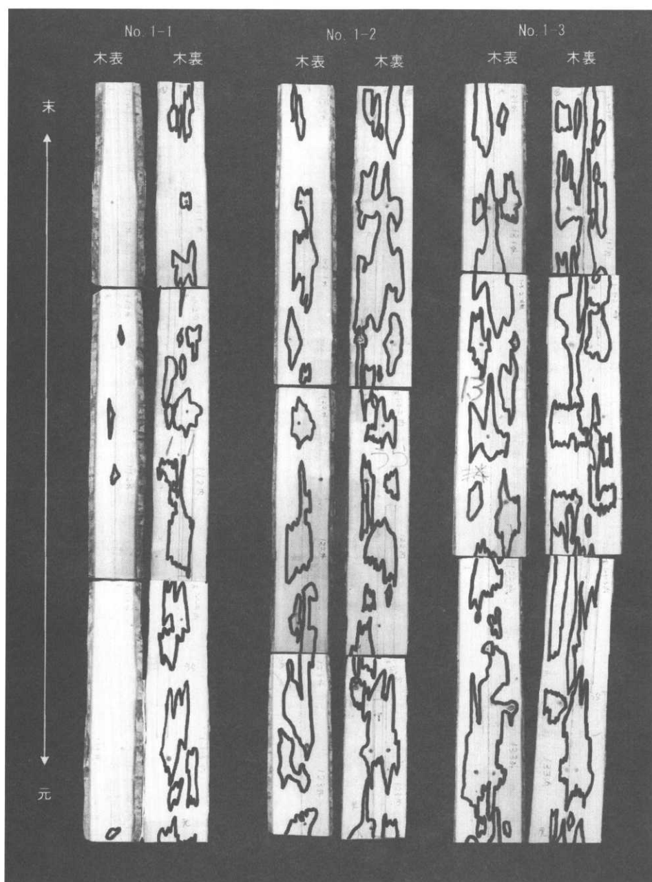
図-16 供試木 1 から得られた板材 (No. 1-No. 3) 内の水食いの状態
