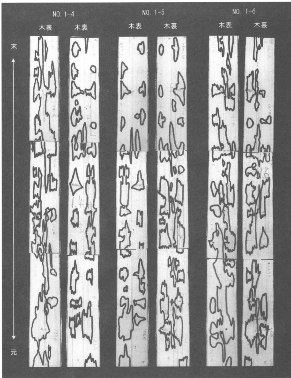
図-17 供試木 1 から得られた板材 (No. 4-No. 6) 内の水食いの状態
