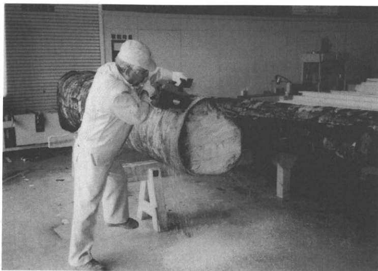
図-9 供試木の両木口の切断
