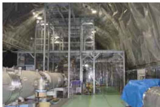
上) KAGRA 試験運転時の制御室: 2016年3月のKAGRAの試験運転開始時にKAGRA制御室に集まった研究者と事務のメンバー。 下) KAGRAで鏡を20Kまで冷却するクライオスタット装置とそれを取り囲むクリーンルーム。
