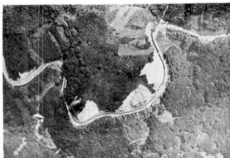
第63図 天城峠南の主要地方道修善寺一下田線に沿う斜面崩壊、降雨による崩落
