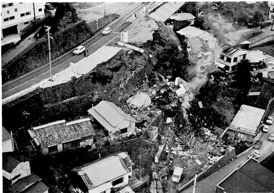
第23図 東伊豆町稲取，崖崩れによる家屋の埋没
