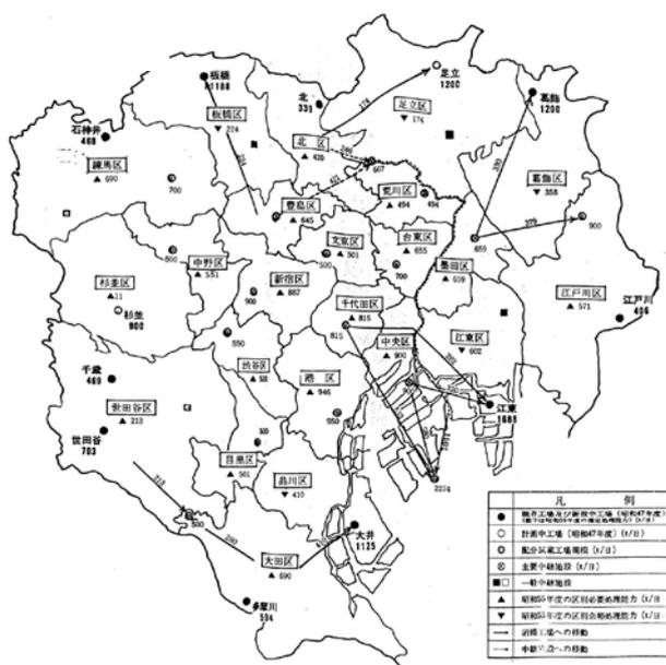
fig2.10 清掃工場と中継施設の規模配分試案
