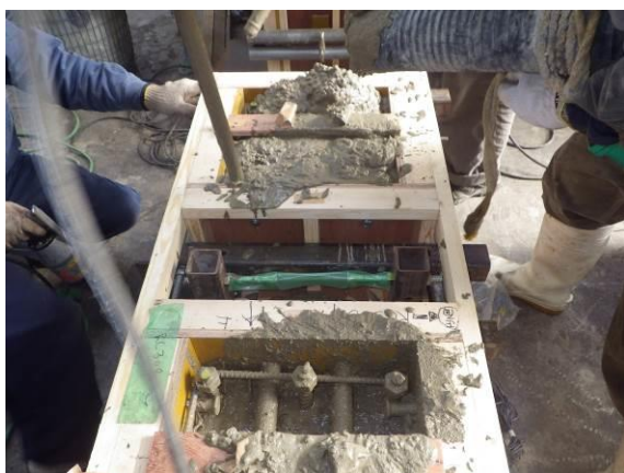
(e) 試験体のコンクリート打設 (スタブ部分のみ)
