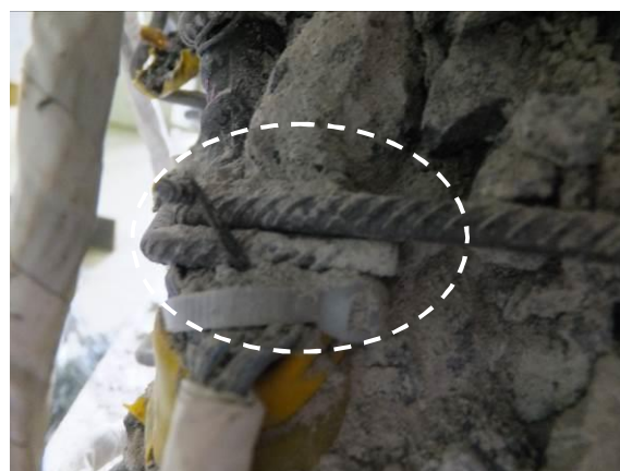
せん断補強筋（K）の破壊詳細
