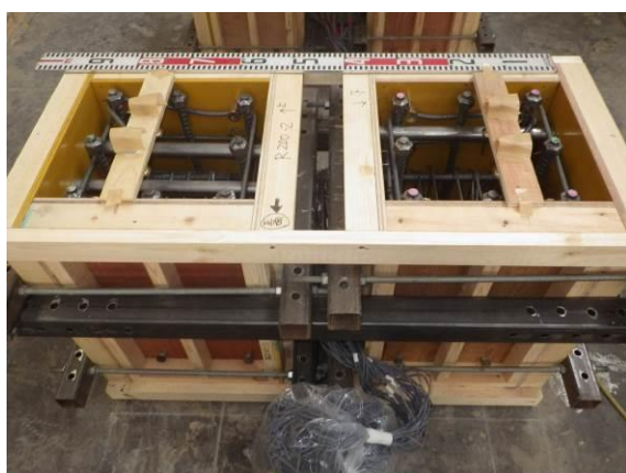
(c) 試験体の型枠支保工
