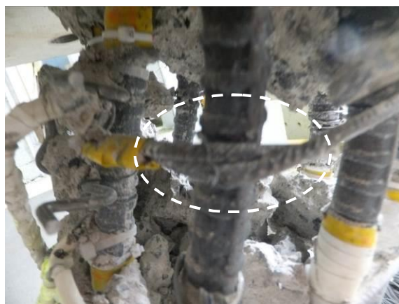
せん断補強筋（I）の破壊詳細
