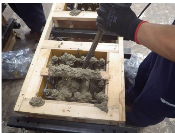
(e)試験体のコンクリート打設
