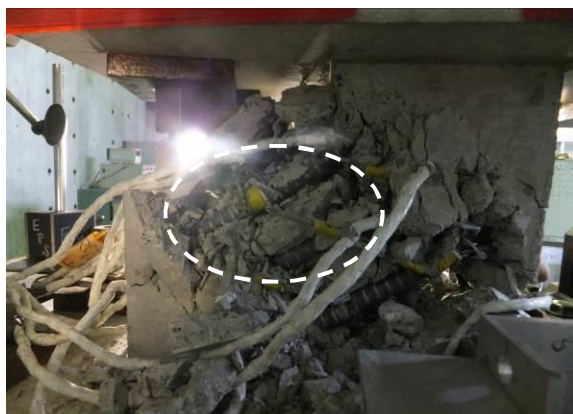
せん断補強筋（J）の破壊詳細
