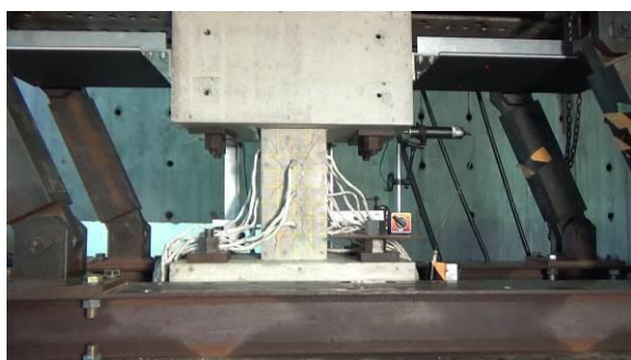
③せん断補強筋が降伏し始める
