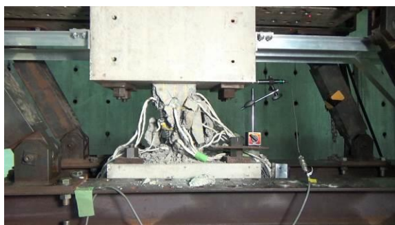
破壊した試験体の全景
