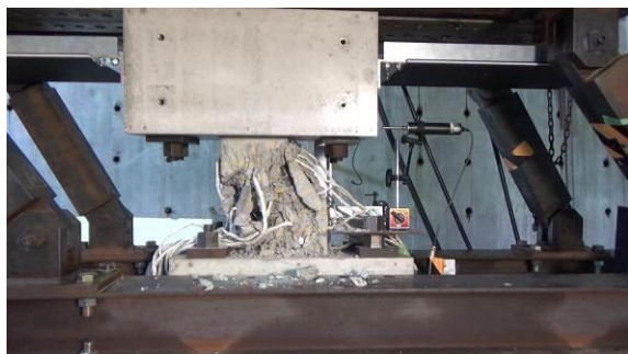
破壊した試験体の全景
