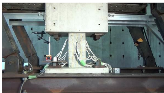
③せん断補強筋が降伏し始める
