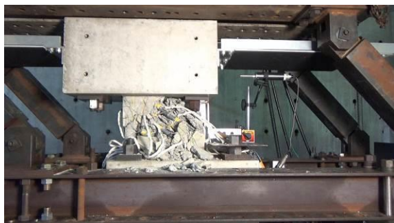
破壊した試験体の全景
