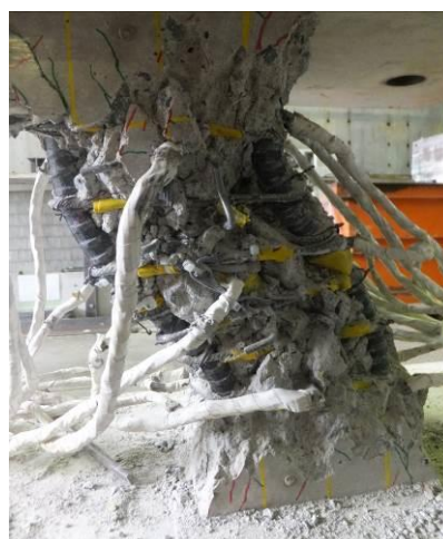
試験体の破壊詳細（正面）
