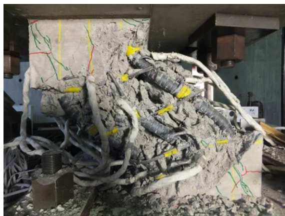
試験体の破壊詳細（正面）
