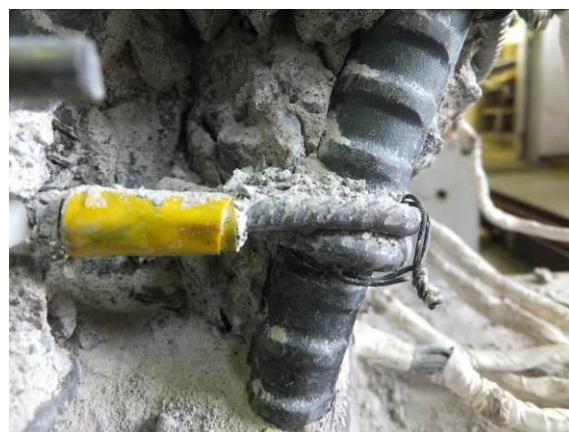
せん断補強筋（I）の破壊詳細
