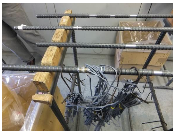
(a) 主筋の歪ゲージ貼付後の様子
