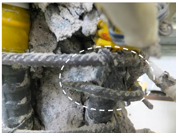
せん断補強筋 (L) の破壊詳細
