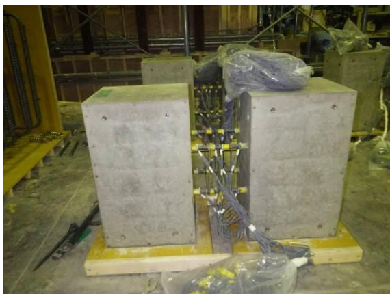
(g) 脱枠後の試験体の様子
