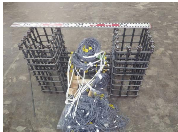
(b) 試験体の鉄筋組立後の様子
