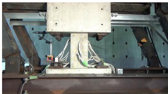
①斜めのひび割れが生じる（左下→右上）
