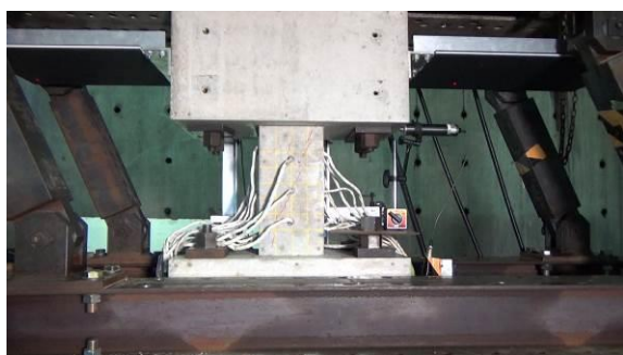
①斜めのひび割れが生じる（左下→右上）
