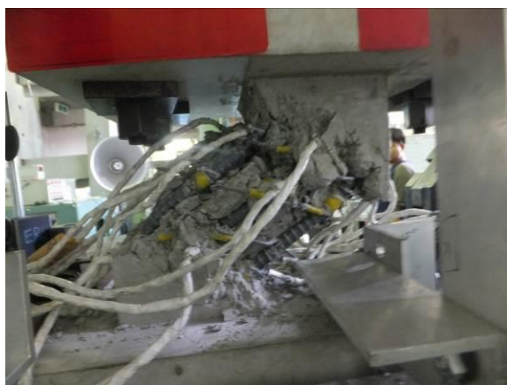
試験体の破壊詳細（裏面）
