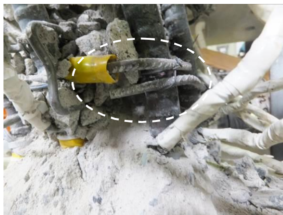
せん断補強筋（K）の破壊詳細
