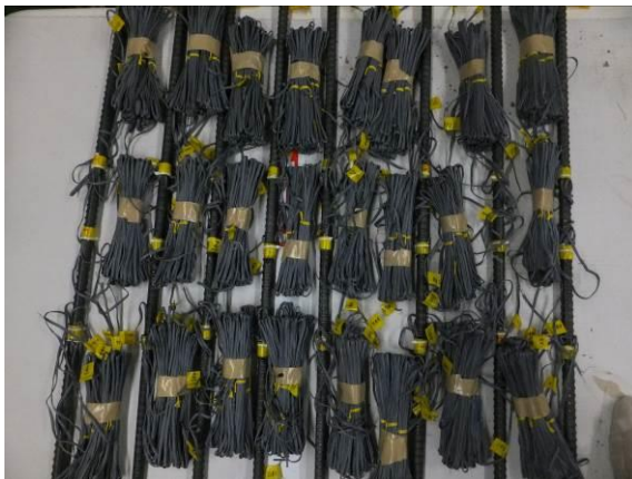
(a) 主筋の歪ゲージ貼付後の様子
