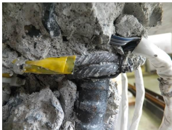
せん断補強筋 (M) の破壊詳細
