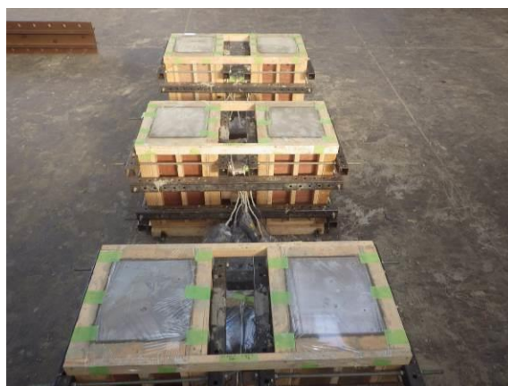
(f)試験体のコンクリートの養成
