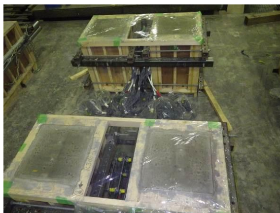
(f) 試験体のコンクリートの養成 (スタブ部分のみ)
