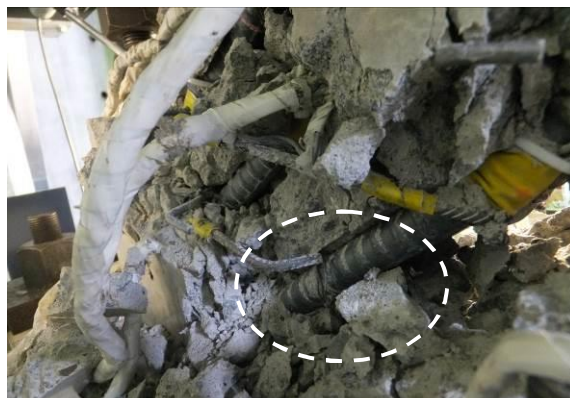
せん断補強筋（K）の破壊詳細
