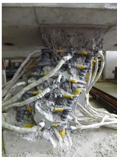
試験体の破壊詳細（裏面）
