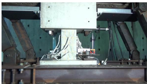
③斜めのひび割れが生じる (左上→右下)
