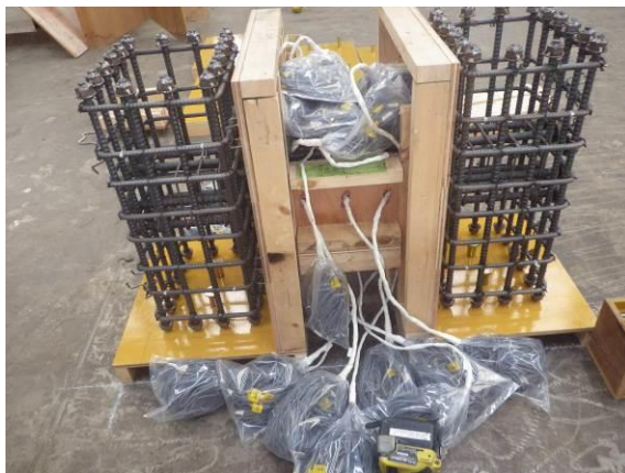
(c) 試験体の型枠支保工
