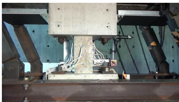
⑦主筋端部が降伏し始める
