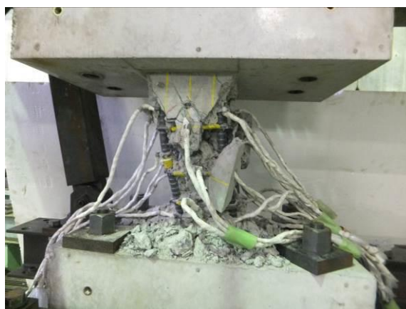
試験体の破壊詳細（正面）
