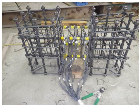
(b) 試験体の鉄筋組立後の様子
