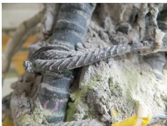
せん断補強筋（J）の破壊詳細
