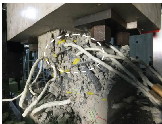
せん断補強筋（I）の破壊詳細
