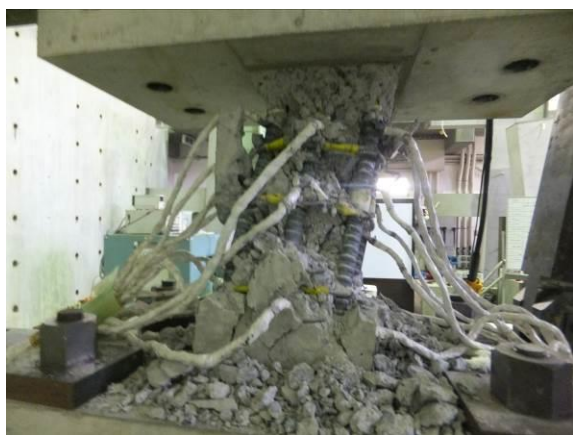
試験体の破壊詳細（裏面）
