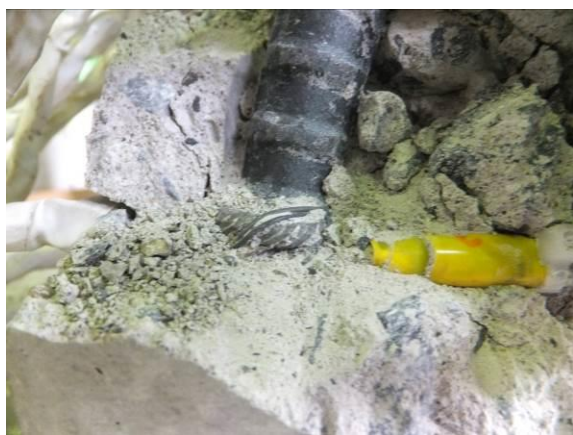
せん断補強筋 (N) の破壊詳細
