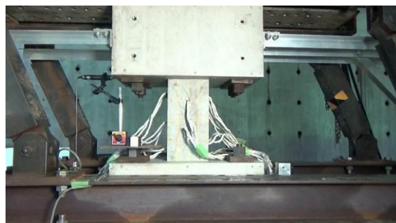
②斜めのひび割れが生じる（左上→右下）
