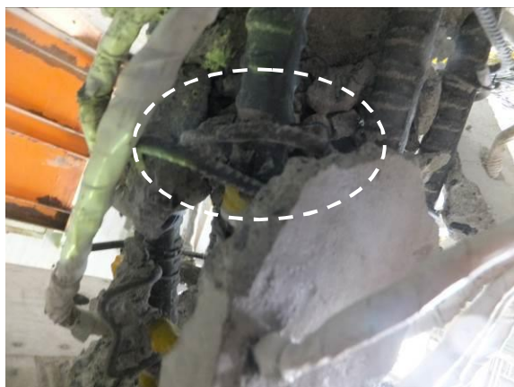
せん断補強筋（J）の破壊詳細
