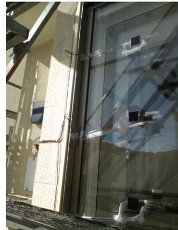
写真-3.3.2 外部窓表面測定装置
