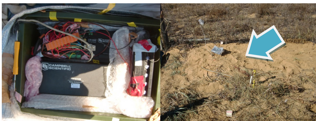
図 II-6.6 Sand におけるロガーの設置の様子. 左) ロガー (CR1000) およびマルチプレクサー (AM16/32B), バッテリー (12V) の配置図, 右) Sand に 20 cm 程度穴を掘り, その中に埋め, 上に砂丘砂を被せ盗難および凍結から保護
