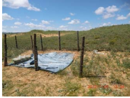
図 II-6.24 Sand における現場透水係数測定の様子。 3×3 m のブルーシートで地表面を覆い蒸発散を抑制
