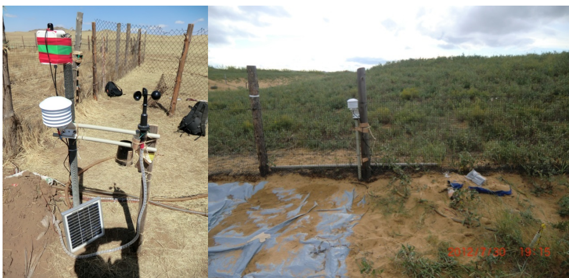
図 II-6.11 左) Steppe 4 における設置の様子。温湿度計および全天日射量計，風速計。右) Sand における設置の様子。
