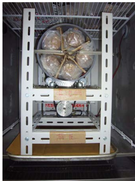
図 I-2.3 チャンバー内の回転装置. 3 分半に 1 回転する.
