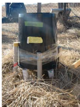
図 II-6.8 雨量計の設置の様子。地面は 5 cm 程度掘り下げ、雨量計は地表面から 5 cm 程度浮かせて固定
