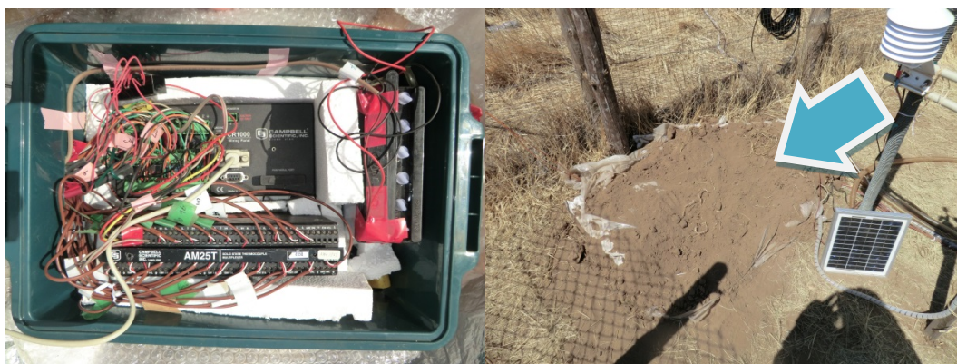
図 II-6.5 Steppe 4 におけるロガーの設置の様子. 左) ロガー (CR1000) およびマルチプレクサー (AM25T), バッテリー (12V) の配置図, 右) 上に土嚢および土を被せ盗難および凍結から保護
