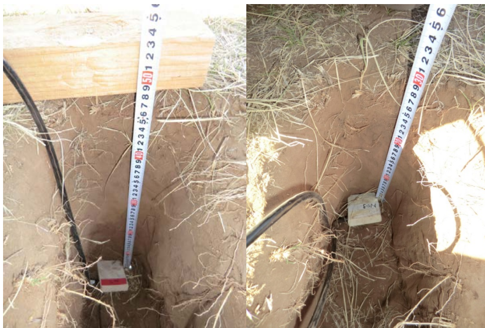
図 II-6.7 Steppe 4 における土壌水分計の設置の様子。Samd においてもほぼ同様に設置した。左) 深度 50 cm から斜めに差し込んだ。右) 同じ穴を使い、深度 30 cm から斜めに差し込んだ。
