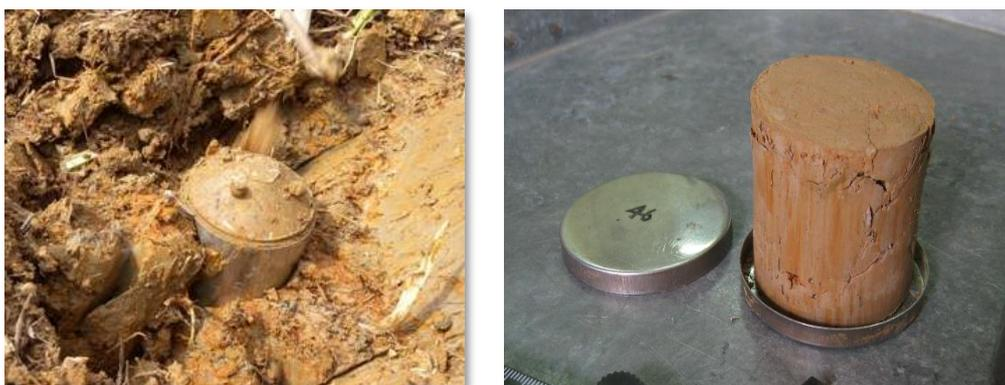
写真 4.1 土壌サンプルの採取時（左）と炉乾後（右）に縮小した様子
