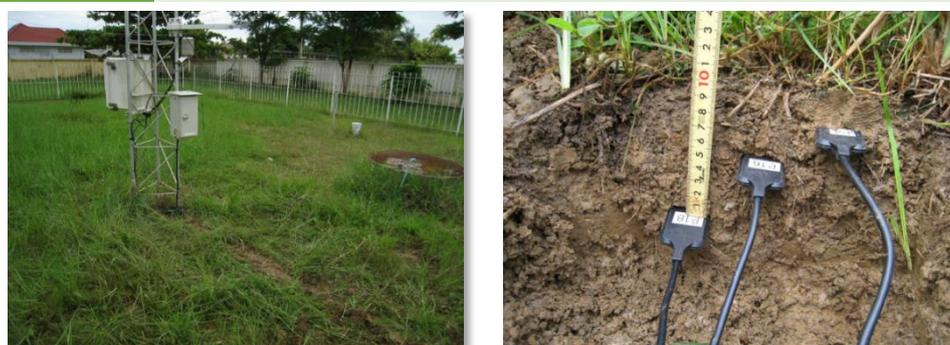
図 4-18 バットバン土壌水分計の設置状況
