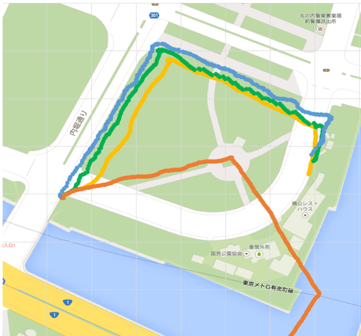
図 5.10. Open Sky 環境下での新しい GPS 精度を適用した実験結果 (橙: PDR (PDR のみ), 淡青: GPS (GPS のみ), 黄: PDR+GPS(conv) (PDR, GPS のフュージョンに従来の accuracy 値を適用させたもの), 緑: PDR+GPS(acc) (PDR, GPS のフュージョンに提案する GPS 精度を適用させたもの))
