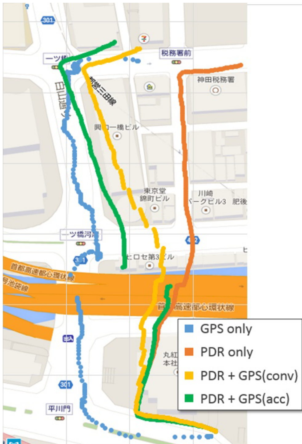
図 5.7. Urban Canyon における新たな GPS 精度を用いた実験結果
