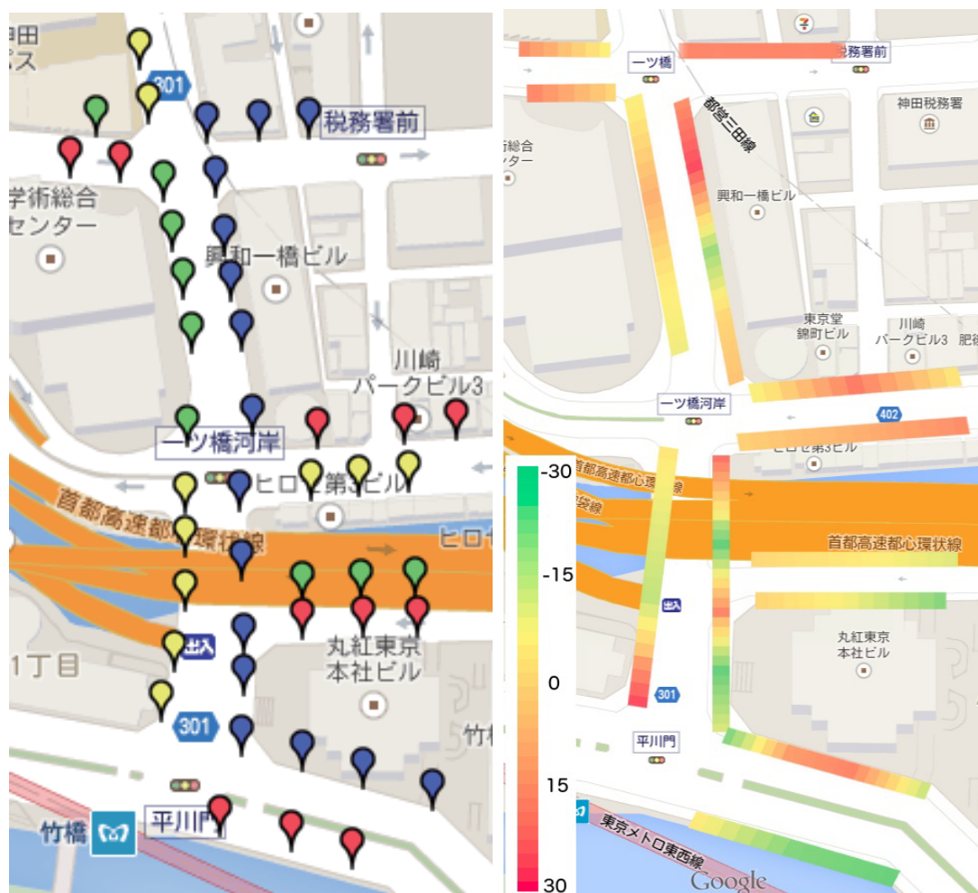
図 5.5. 一ツ橋での磁場偏向マップサンプル点と、主要な道での磁場偏向カラーマップ
