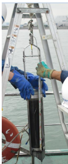
図 2-6 柱状コア採泥後のサンプルの厚さを測定する様子
