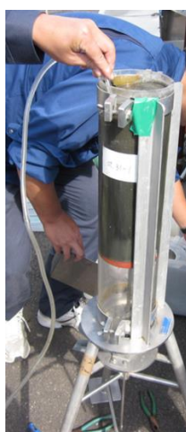
図 2-8 柱状コアサンプルの直上水をサイフォンで除去する様子
