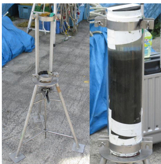
図 2-7 柱状コアサンプルを固定した様子
