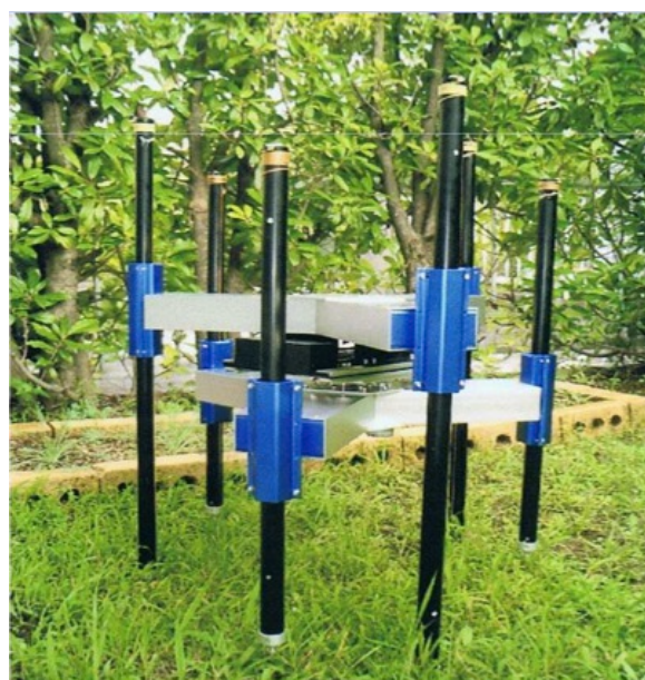
図 2.16 Fukatsu [45] によって開発された Mobile Robot Field Server。Fukatsu [45] の図を引用。
