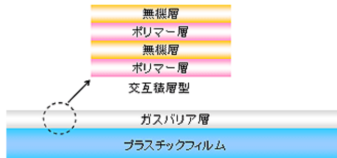
図 3.2 スーパーバリアフィルムの構造[61]
