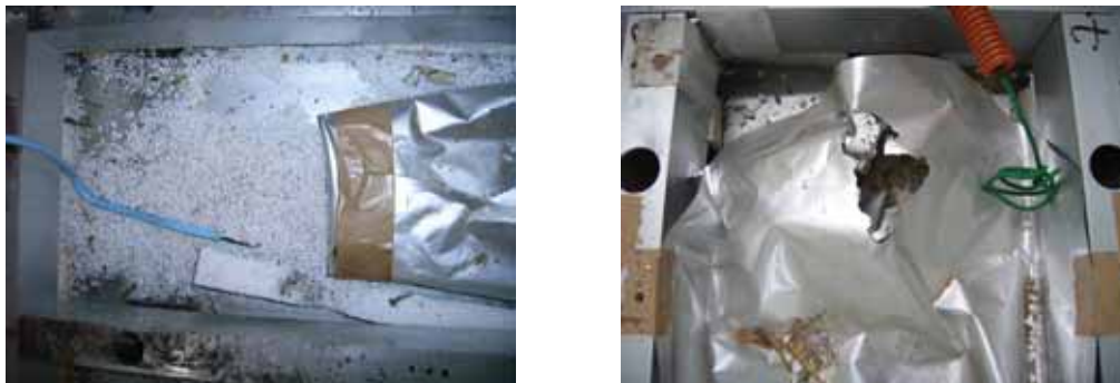
図表 3.2 - 10 アクアレイヤのネズミによる被害
