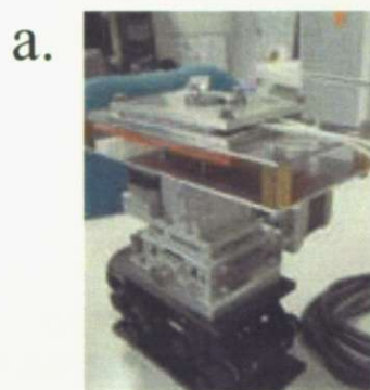
Fig. 8.4: 自作した温度調節機能付き GI-SAXS ステージの写真。a は蓋を外したところで、b は蓋をかぶせたところ。
