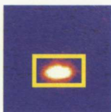
Fig. 8.12: 予備実験の高さスキャンにおける direct beam 像。黄色の四角は強度を積算する範囲を表す。
