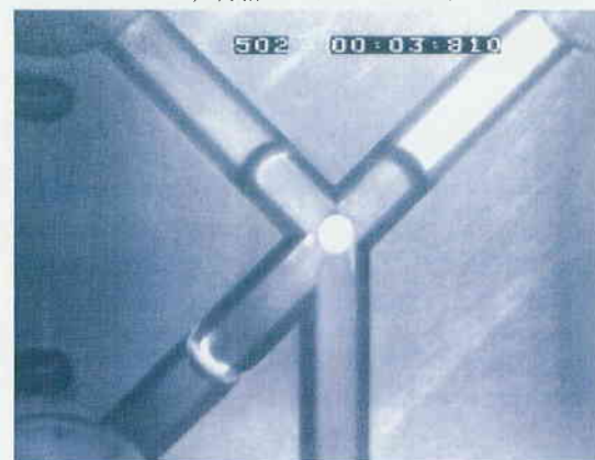
写真7 ランナー分岐部流れ (樹脂：ポリスチレン)
