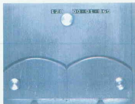
写真9 2点ゲートによるウェルドラインの生成 (樹脂: ポリスチレン)
