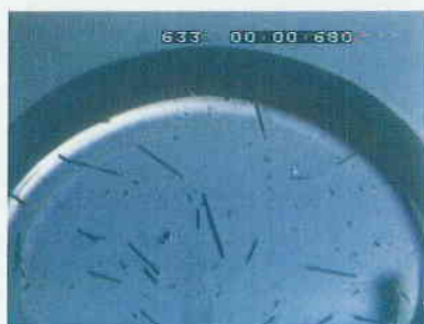
▲ ゲート 写真14 ゲート近傍での繊維配向 (樹脂: ポリスチレン, ガラス繊維: \phi 60\mu\text{m} )
