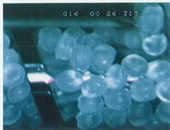
写真2 ベレット噛み込み状況 (樹脂：ポリプロピレン)
