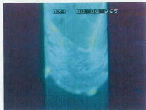
写真13 キャビティ厚さ方向に揺動する非対称なファウンテンフロー現象 (樹脂: 低密度ポリエチレン, レーザライトシート金型)
