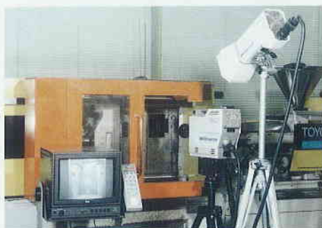
写真6 プリズムインサート金型と高速ビデオシステム
