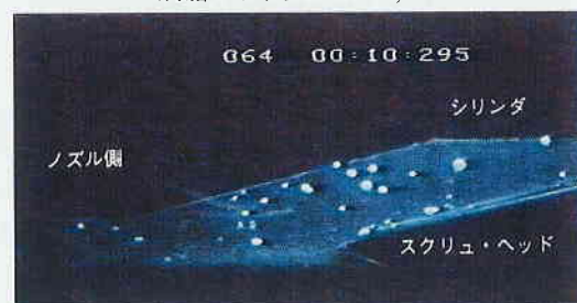
写真5 リザーバ内樹脂挙動のレーザ可視化 (白い点： マーカ、樹脂：ポリプロピレン)
