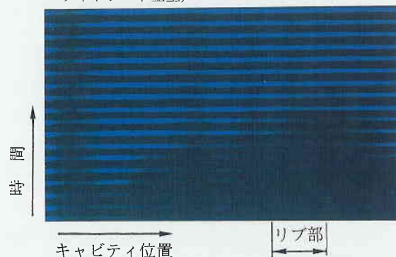
↑ 型 ↓ 型 ← キャビティ位置 → ← リブ部 → 写真15 超音波イメージスキャナによる型内離型プロセスの画像計測 (樹脂: ポリプロピレン, 線が見える部分は離型が完了したことを意味する)
