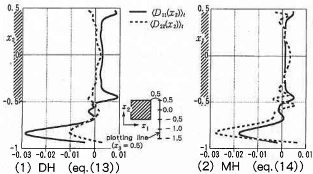
図 7  $\langle D_{11}(x_2) \rangle_t$  と  $\langle D_{22}(x_2) \rangle_t$  の水平分布 (立方体後方) ( $\langle D_{11}(x_2) \rangle_t$  と  $\langle D_{22}(x_2) \rangle_t$  の値は CASE 1-1 の時間平均値を用いて計算した)
