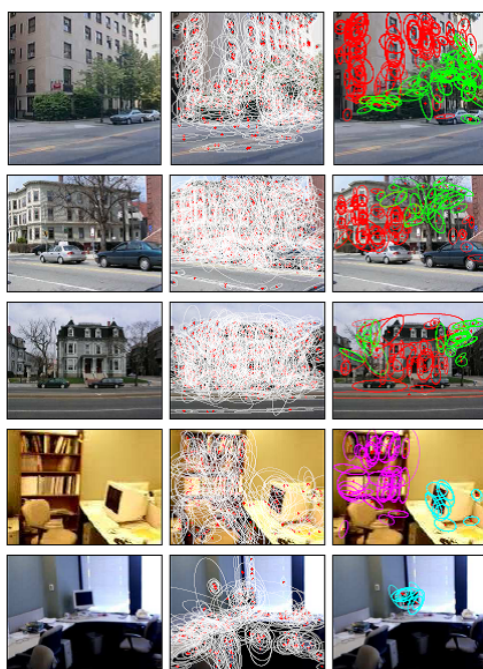
Fig. 2.7 Doublet による画像の表現 25) ：Doublet による記述により複数カテゴリの物体も認識できている．
