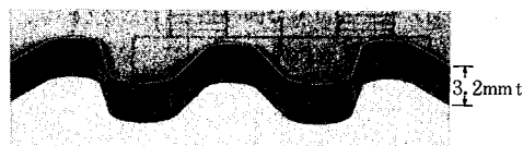
図 2 NCレーザ切断機による工具鋼板の切断面 (P=2 kW, Pulse, SK 5, 3.2 mm)
