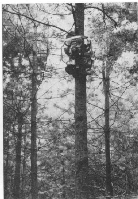
図-7 自動枝打ち機によるチョウセンゴヨウマツの枝打ち作業. Fig. 7. Pruning with remote controlled pruning machine.
