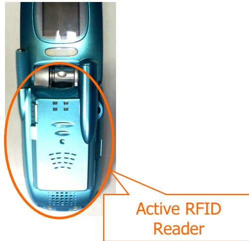
図 2.22: 携帯電話に取り付けられたアクティブ RFID タグリーダ
