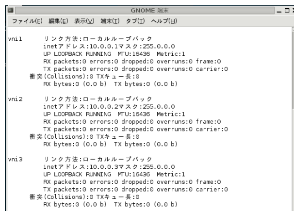
図 2.18: 複数の仮想ネットワークインタフェースが作成されている様子 (Linux 版)
