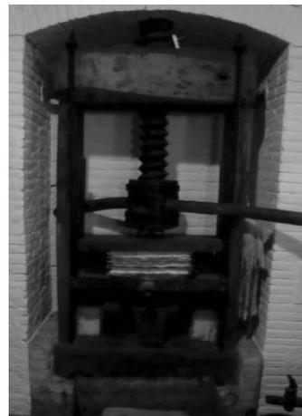
fig. 18 余分な膠を搾り取るプレス機
