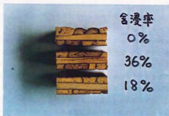
写真8.3. フェノール樹脂含浸ボードの冷水浸せき厚さ膨潤
