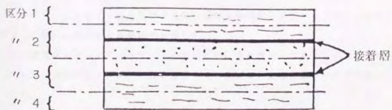
図 5.2. 削片の切り出し区分
