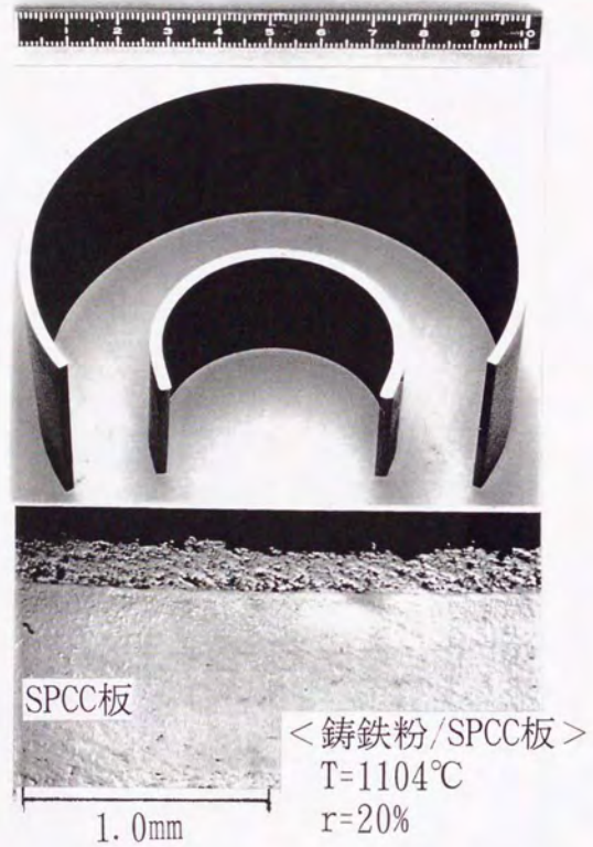
図 7-47 積層型複合板材の冷間曲げ加工例
