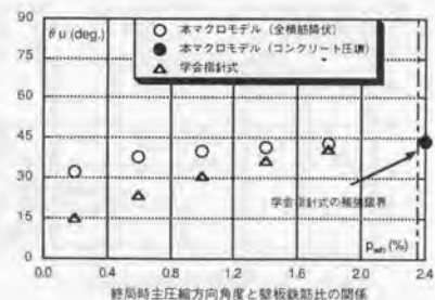
図8.3.6 終局強度、壁板横筋の負担率及び主圧縮方向角度と壁板鉄筋比の関係 (既往のせん断終局強度算定式との比較: M/QD=3.0 )
