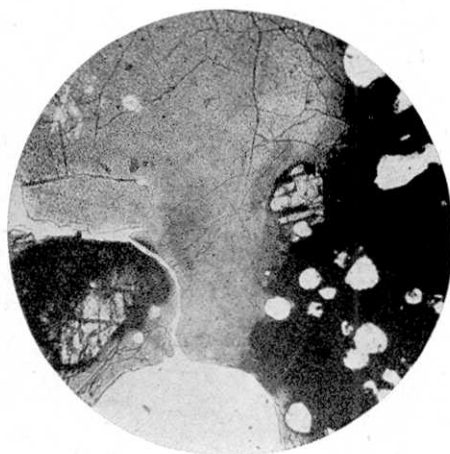
第 10 圖 前に同じ(×26). 玻璃の部分には熔融せ ざる橄欖石斑晶殘存す。
