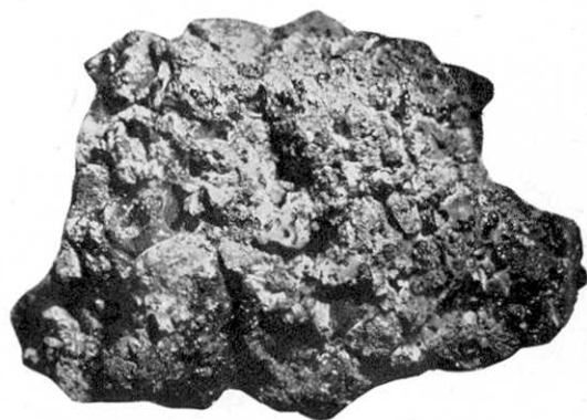
第 6 圖 火山砂礫の間隙に發達せる玄武岩玻璃(淡灰色平滑なる部分及び黑色にして光澤ある部分), 富士山頂産, 原寸。
