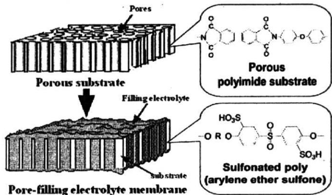
ここで用いた電解質ポリマーのスルホン化ポリエーテルスルホン(SPES)は、スルホン酸基が集合した数十 nm 程度の大きさの親水的なマイクロ相分離構造を形成して相互に接続することによってプロトン伝導パスを形成する。スルホン化度が高いとプロトン伝導性も高くなるが、キャスト膜ではポリマーが膨潤するためメタノールの透過性も高くなる。一方、全芳香族炭化水素系細孔フィリング電解質膜は、高いスルホン化度においても多孔質ポリイミド基材の膨潤抑制効果によって含水率が低く抑えられ、メタノールの透過が抑えられていると考えられる。本発表では、SPES のキャスト膜と細孔フィリング電解質膜について、スルホン酸基周辺の水の構造やポリマーのマイクロ構造を解明し、それに基づいてプロトン伝導性やメタノール透過性について考察する。
