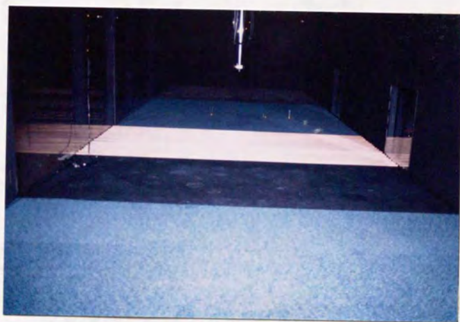
図4-6 風洞実験の様子 (地表面粗度長を変化させた場合)
