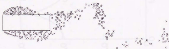
Fig.5-10 B/D による離散渦分布の変化 ( U=0.60\text{m/s} , T=24 )
