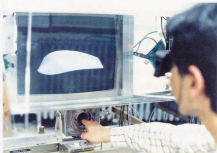
Figure 9.2.1 触覚ディスプレイを用いた翼の形状設計
