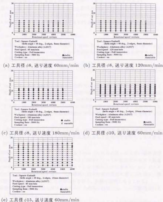
図 5.4 カベクトルの軌跡による実験的安定限界線図 (間値 5000 N 2 )
