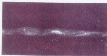
写真 4-2-2 せん断層の不安定性の形成 ( R_i \approx 25 )
