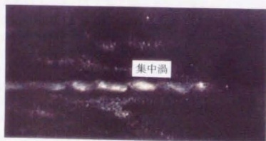
写真 4-2-3 せん断層内での渦度の集中 ( R_i \approx 5 )
