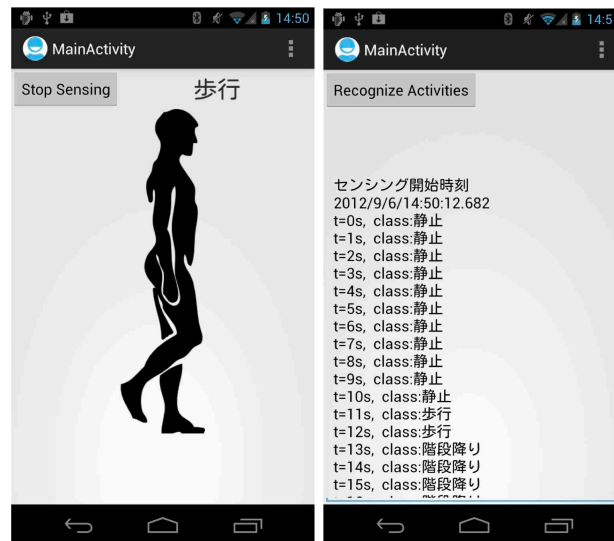
図 2.4: Android 上で行動認識を行うデモアプリケーションの動作例
