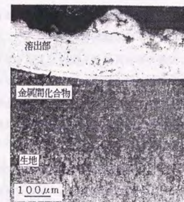
(d) 浸硫窒化処理金型鋼, 10 h
