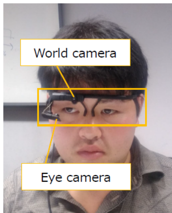
図 4.1: Pupil Pro. 図に四角で示した部分がカメラになっている.
