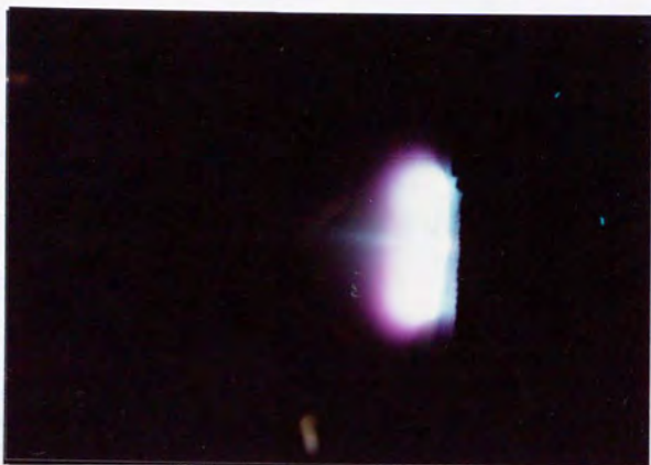
第 5 ・ 5 図 ホローカソードを用いた場合のホールスラスタの作動の様子
