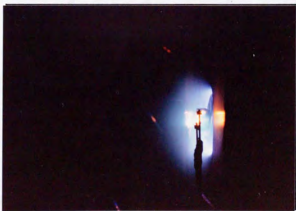
第 5 ・ 6 図 フィラメントカソードを用いた場合のホールスラスタの作動の様子
