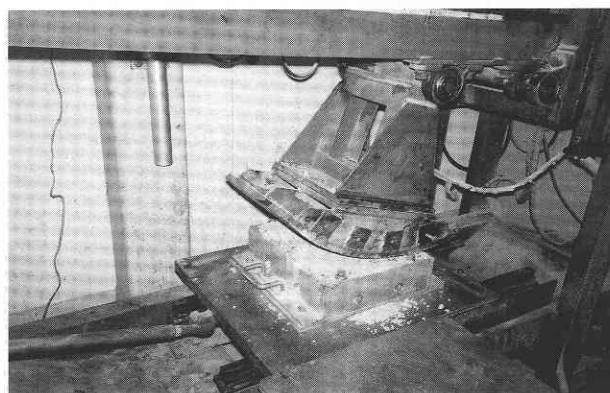
図2 加熱骨材の締固め作業状況
