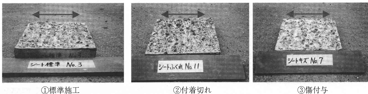
図3 表面骨材を除去した状況 (シート系防水工)
