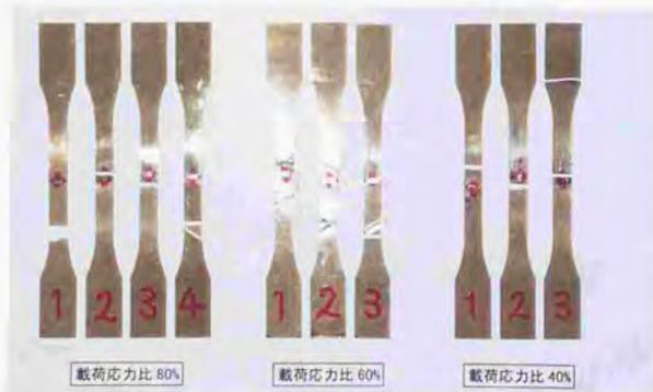
写真 4.2.2(a) AFRP ロッド用マトリックス樹脂のクリープ破断状況
