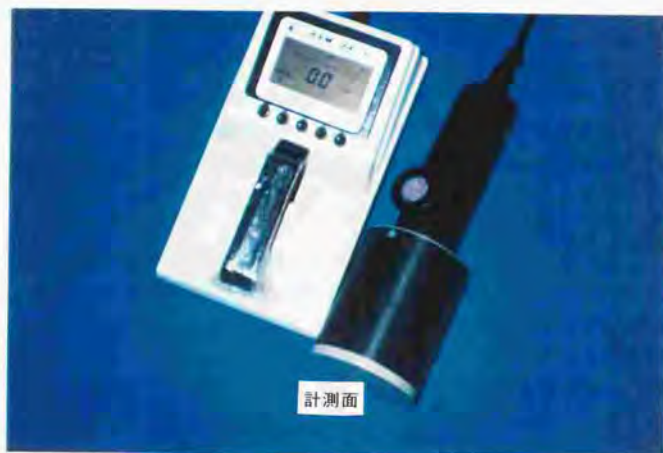
図3.8 電離箱型X線線量計
