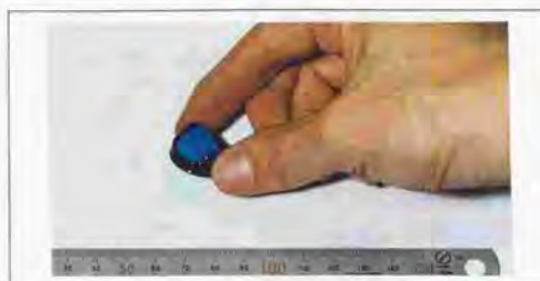
図6.5 製作したオクルーダを St. Jude Medical 弁のヒンジに挿入した図 (オクルーダ重心のずれにより閉鎖状態で静止する)
