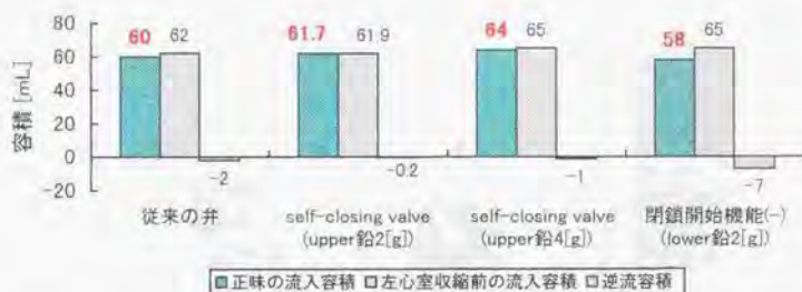
図5.19 二葉弁を用いた閉鎖開始機能の評価実験における左心室への流入容積の比較 (拍動数: 60 [bpm], 拡張期時間: 0.8 [s], 平均流量: 0.5 \times 10^{-4} [m 3 /s] (3 [L/min]))
