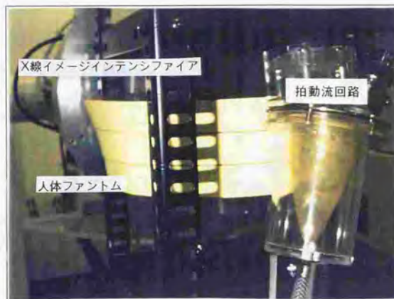
患者撮影の模擬実験（人体ファントム+拍動流回路内の機械弁）
