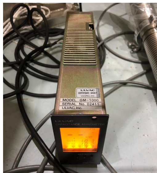
図 3.4 リザーバタンク内のガス圧を計測する真空計
