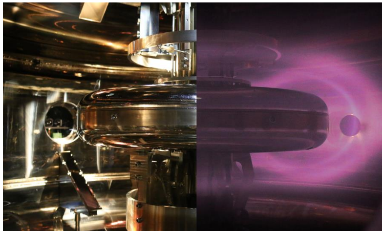
図 2.4 RT-1 の真空容器内部 (左:プラズマなし,右:プラズマあり)
