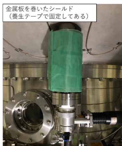
図 2.9 シールドをしたイオンゲージの概観
