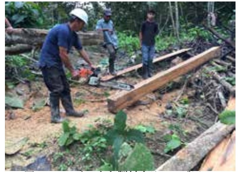
図 3-3-10. チークを製材するファビアン
