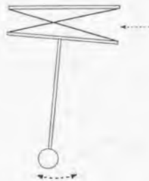
図 1.9: X-pendulum 概略図。矢印のたすき掛け状に張ったワイヤによって下部構造が下り下げられる。
