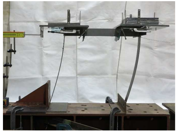
図 3-21 試験体 b 加力中 ( Q = 0.0070 \text{ kN} )
