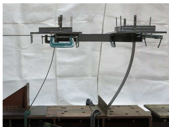
図 3-16 試験体 a 終局時 ( Q = 0.0115 \text{ kN} )
