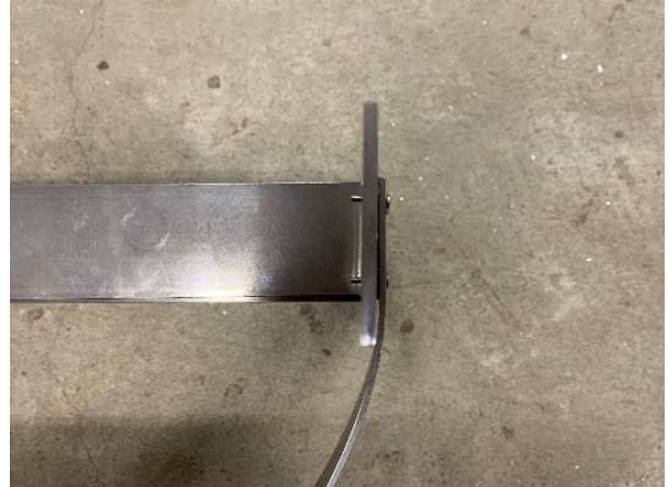
図 3-33 柱 2 柱頭の塑性化
