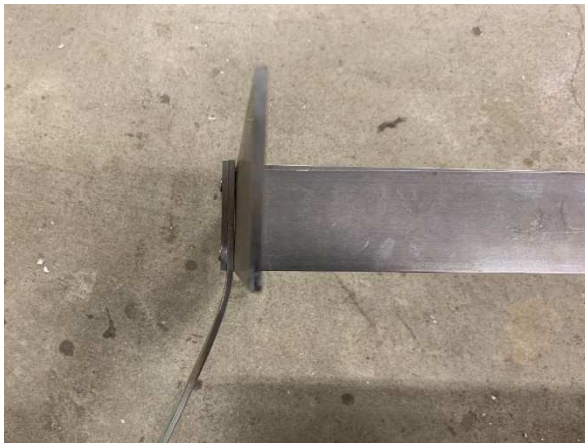
図 3-32 柱 1 柱頭の塑性化
