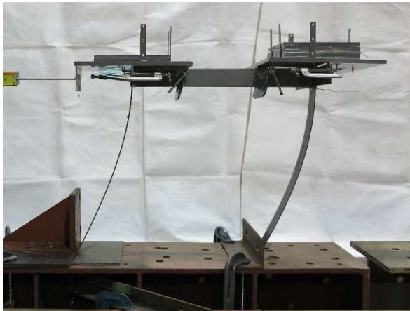
図 3-22 試験体 b 終局時 ( Q = 0.0129 \text{ kN} )
