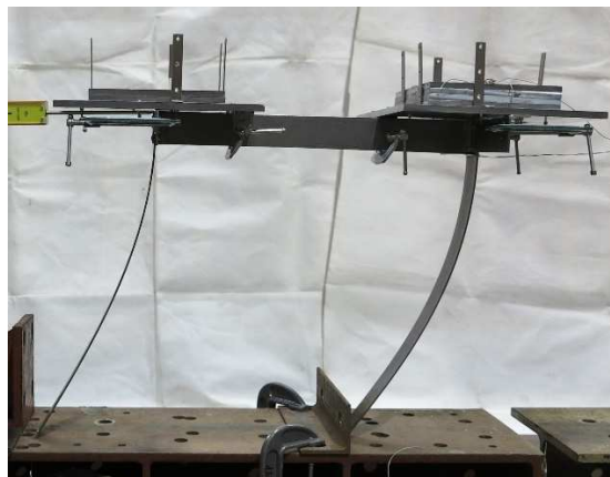
図 3-29 試験体 c 実験終了 ( Q = 0.0187 \text{ kN} )
