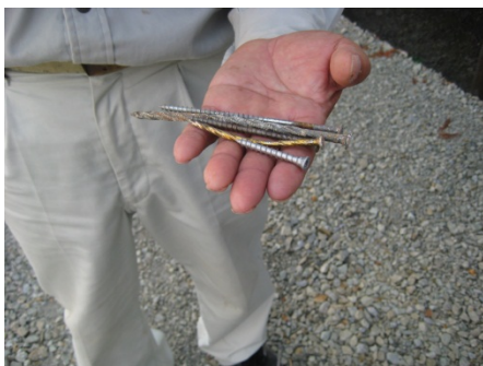
図 5-74. SY 社が解体作業で引き抜いた多種多様な釘・ビス
