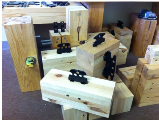
図 5-11. A 社の採用構法における金物接合部分
