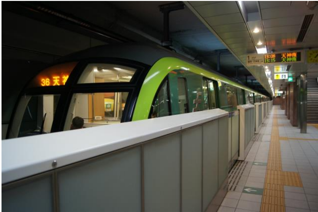
図 2-6 鉄輪式リニアモーター車両
