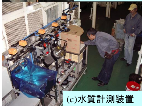
図-3.4 フェリーへの各種計測装置設置状況
