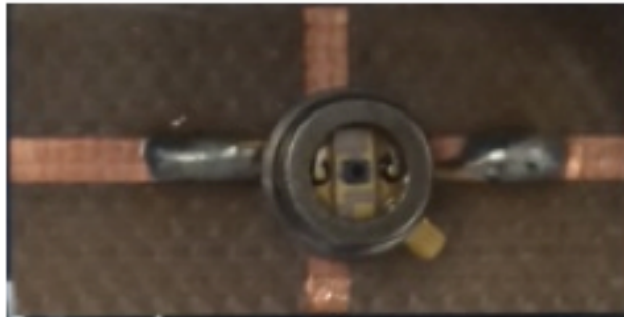
図 4.3 チップキャリア上への Si PIN フォトダイオードのハンダ付け。
