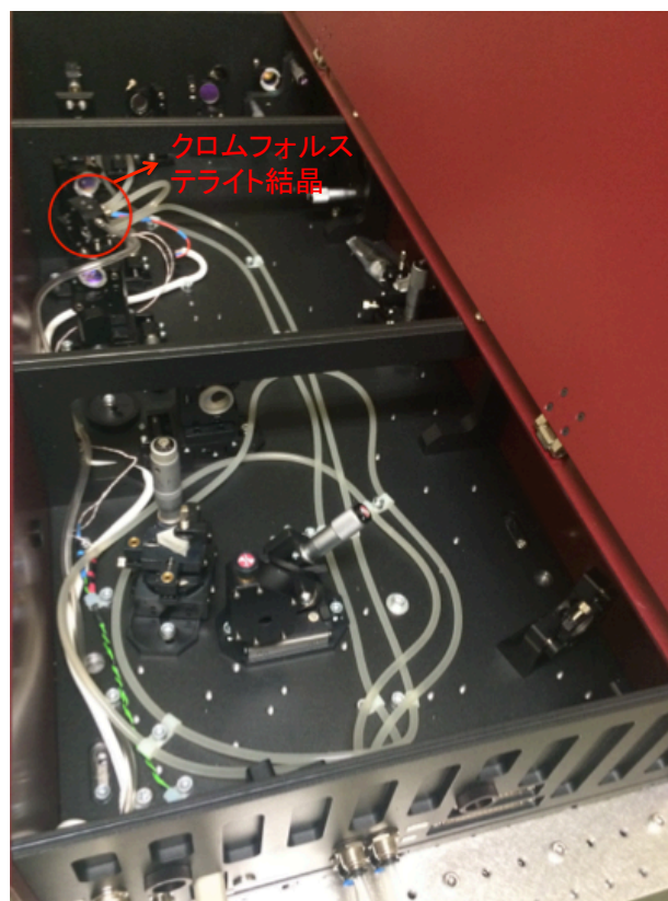
図 3.6 クロムフォルステライトレーザの内部構造。
