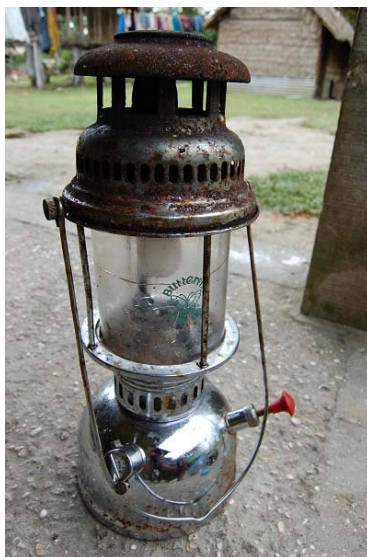
写真 5.2 加圧式灯油ランタン、通称「バタフライ」（傘を外した状態）
