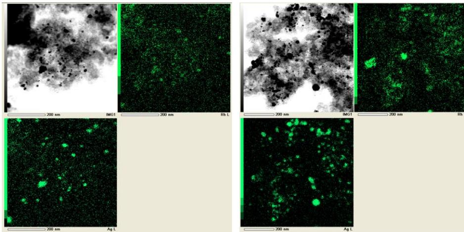
**Fig. 1-2-7. EDS analyses of PI/CB Rh/Ag IV-3**
