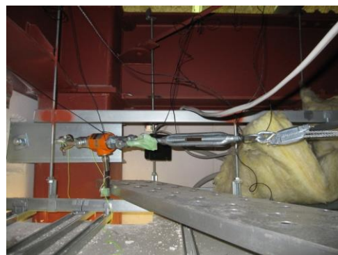
図 C. 1.5.9 ロードセル設置
