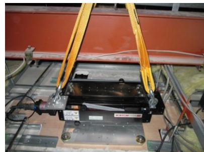
図 C.1.5.3 起振器設置
