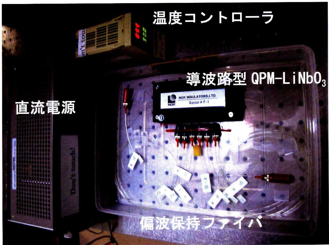
図3. 3 実験に用いた導波路型 QPM-LiNbO<sub>3</sub>デバイスの外観.
